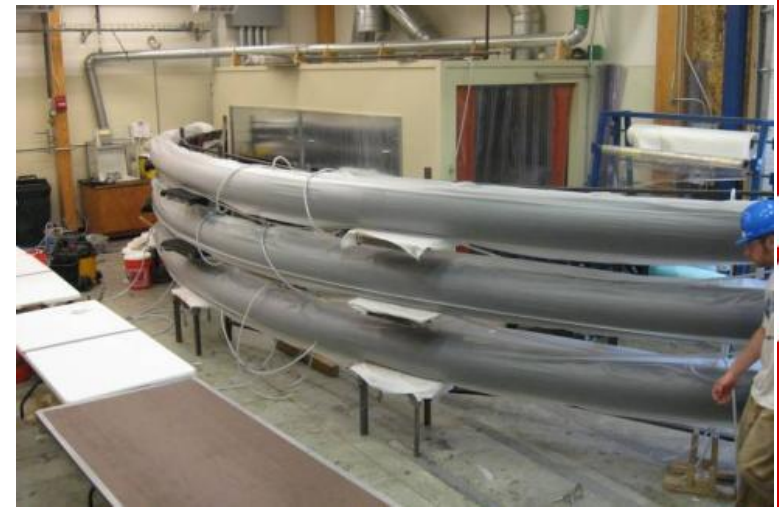
Производство 3-х пролетных композитных арок длиной 10,5 метров в лаборатории
