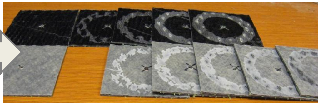
Углеродные композитные ламинаты на испытаниях на износ
